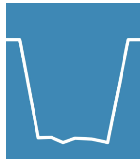
2.1 Dåligt förberedd schaktbotten
