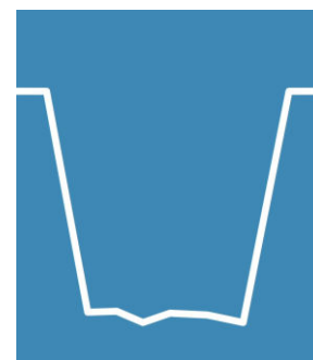
2.1 Dåligt förberedd schaktbotten
